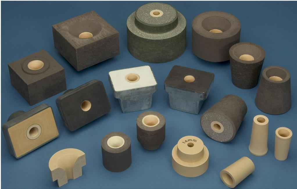
迪胜特制陶瓷公司制造各种适用于连续铸钢的氧化锆定径水口。这些水口既可以单独供应，也可以和共同模制的高铝外套一起供应。过去供应的往往是单一材料定径水口，但是近年来，许多顾客出于节约成本的目的都更青睐复合水口。迪胜公司首创复合水口制造方法，使得水口制造过程中无需采用水泥勾缝，而是采用嵌件和按压外套。这种制造方法使得整个系统内嵌件和外套之间没有漏钢的风险，非常可靠。
